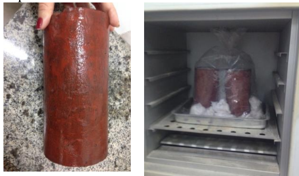
Figura 1. Concreto vermelho de 3ª Geração: a) após a desmoldagem, apresentando coloração vermelha mais intensa, b) corpos de prova sendo curados em estufa a 50°C com elevado teor de umidade.
